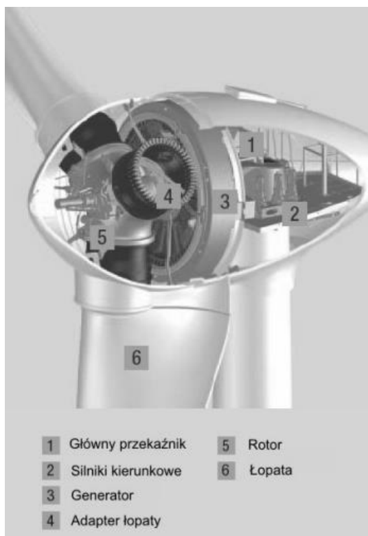
Rysunek 5 Schemat budowy elektrowni wiatrowej.
